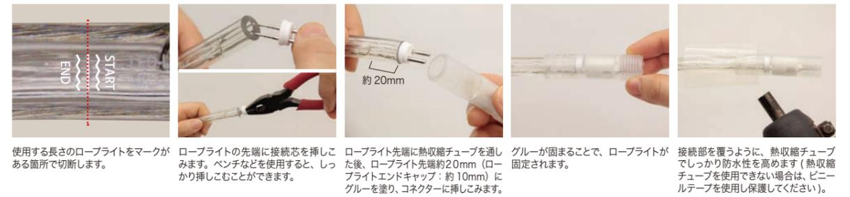
使用する長さのロープライトをマークがある箇所まで切断します。
