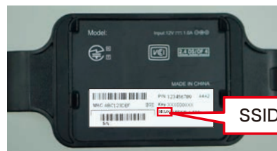
ルーターのラベル
