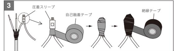
電源線と本体からの電源口出線を、圧着スリーブでかきつけて結線してください。圧着箇所には自己融着テープと絶縁テープを巻きます。アース線には丸形端子をかきつけて取り付けます。
