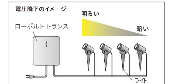
ローボルトライトの電圧低下許容範囲(ローボルト12V)
