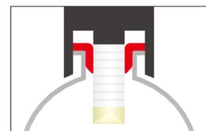
屋外空間で使う場合は常に振動にさらされて、ランプの接触が不安定にもなりかねません。微振動による内部部品のずれしるを抑え込む構造で、安心してお使いいただけます。
