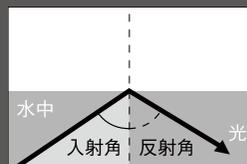
入射角が48.6°を超えると光は外へ抜けず、反射します。
