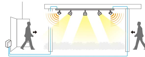
ローボルトレールの両端に人感センサー付きフィードイン
