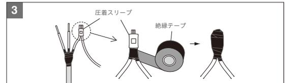
結線箇所の防水、絶縁処理を行います。電源線と本体からの電源口出線、またはアース口出線を、圧着スリーブ等でかきつけてください。圧着箇所に絶縁テープを巻きます。
