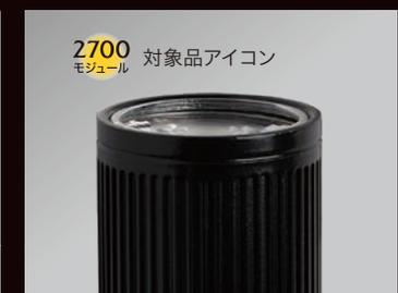
オルテックS/M、同ユニバーサルS/Mは交換可能なLEDモジュールを採用。万が一不具合が起きた場合でも光源だけの交換が可能な構造です。
