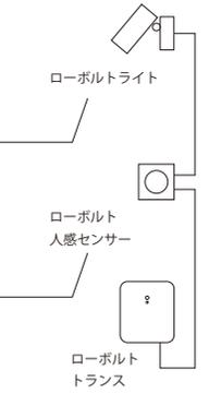
トランスとライトの間にセンサーを接続するだけで、ローボルトライトがセンサーライトとして機能します。
