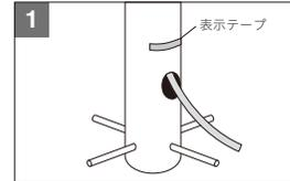
ポールにネカセパイプを差し込み設置します。電線保護管を引き込み、表示テープの位置までポールを埋め込んでください。
