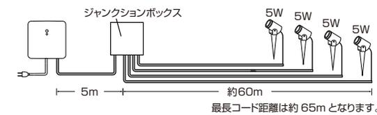
ジャンクション・ボックスを使用して分岐させた場合、1ラインあたりのW数が軽減されるので、左図より最長コード距離は約65mとなります。
