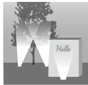
光源部の前後スイングに加えて左右の回転機構を追加(詳しくは右ページ)。プラン上、対象物と灯具の位置にズレが生じていても、まるでアップライトのように的確に対象物を狙えます。
