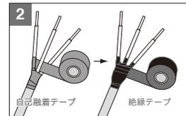
電源線外皮の切り口に防水処理を行います。自己融着テープを巻き、さらにその上から絶縁テープを巻きます。
