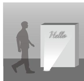
狭角配光のユニバーサルに対して光をワイドに拡散させるのがスプレッドレンズ付。照射面の光の均斉度が上がるため、店舗サインなど幅の広い対象物を照らすのに適しています。
