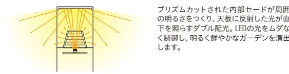
プリズムカットされた内部セードが周囲の明るさをつくり、天板に反射した光が直下を照らすダブル配光。LEDの光をムダなく制御し、明るく鮮やかなガーデンを演出します。
