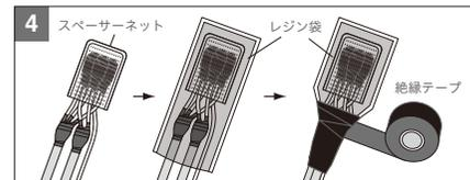
結線箇所の防水処理を行います。結線箇所を、「スコッチキャスト低圧電線防湿用パツクレジンWS-Q」のスペーサーに入れ、さらにレジンの袋に入れて、袋の口をテープで巻きます。
