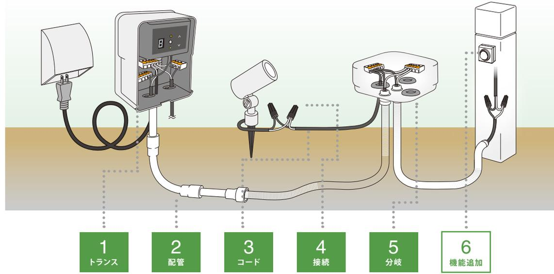
低電圧で、センサー管理もできるローボルトトランス。
