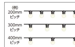
選べる灯具ピッチ(間隔)は200mmから900mmまで、100mm単位で8種類。空間スケールから割り出して、よりイメージに近い仕上がりを実現できるラインアップです。
