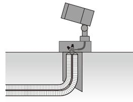
スパイク内に電線保護管2本を引き込むことができ、スパイク内の結露も可能です。
