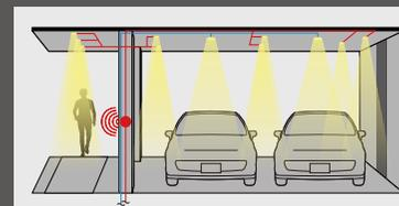
ファサードの一部として車を照らす演出のための光と、アプローチや車の間の通路などを照らす安全のための光に分けてプランしましょう。人の移動のための光を人感センサーにつなぐことで、無駄を抑えて省エネを実現することができます。
