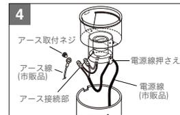
電源線の外皮部分を電源線押さえでしっかりと固定してから、本体をポールに取り付けます。アース線の接地端子をアース接続ネジで固定し、D種接地工事を行ってください。
