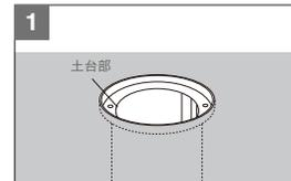
土台部に電線保護管を引き込み、コンクリートで固定します。
