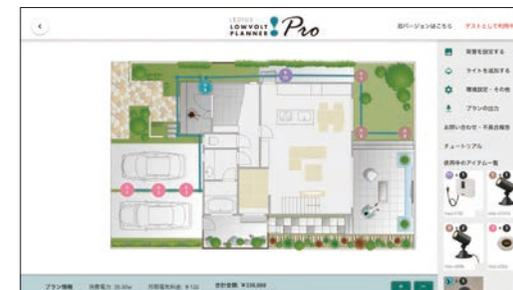
平面図を画面にアップロードし、プランニングしながら部材を自動拾い出せます。電圧降下も自動判定されるので面倒な電圧降下の計算も必要ありません。また拾い出しから見積書も作成できます。
