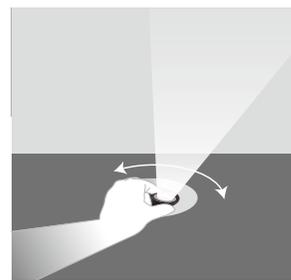
従来品は灯具を取り出しての調整が必要でしたが、オルテックユニバーサルは灯具を設置場所に埋め込んだ状態で照射方向を調整できる構造。光を見ながらシューティングできるので直感的な作業が可能です。
