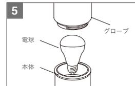
本体ソケットに電球を装着し、グローブを固定して完了です。
