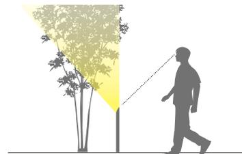
斜めにカットされた支柱上端は、アップライトのフードと同様に立ち上がりの方を手前に向けてすることで、眩しさを抑えることができます。
