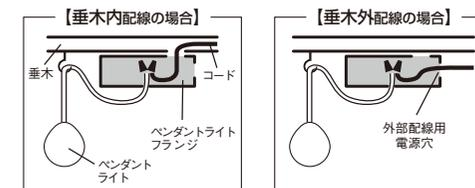
配線を行う際に、ドライコンでの結線部分を露出させずに、スッキリ収納できます。照明器具を後付で施工した場合も、外部配線用電源穴からコードを引き込み、結線部分を納めることが可能です。
