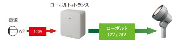
ローボルト®トランスにより、低電圧(12V/24V)に変換して照明を点灯。安全性が高いため、電気工事士の資格がない方でも取り扱いが可能です。
