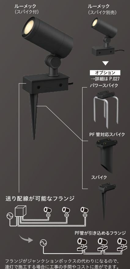
フランジがジャンクションボックスの代わりになるので、連灯で施工する場合に工事の手間やコストに差がでます。
