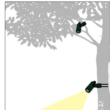
取付バンドを幹に取り付けて設置するので、様々な太さの幹に柔軟に対応できます。
