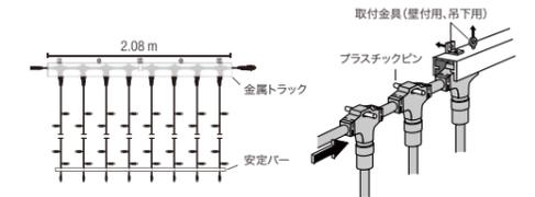
カーテンレールのような感覚で、簡単で美しい施工が可能な取付用のトラックです。
